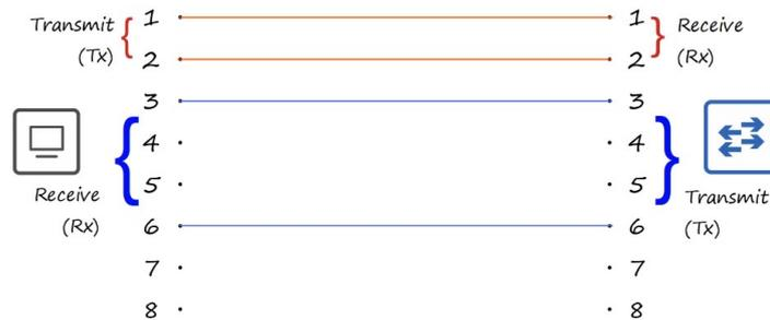
La transmission des données se fait de la même manière qu'entre un routeur et un switch, c'est à dire qu'il transmet les données avec les pins 1 et 2 et reçoit les données sur les ports 3 et 6. Puisqu'ils reçoivent les données sur les mêmes pins il n'y a pas vraiment de problème, ces câbles sont appelés des câbles Straight-through cable car les pins d'un sens se connectent directement au pin de l'autre sens.
